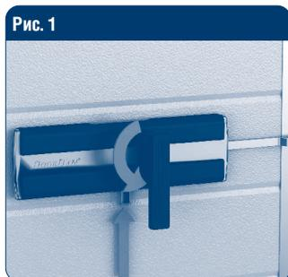
Переместить фиксатор блокировки ручки замка в открытое положение и повернуть ручку на 90° против часовой стрелки.
