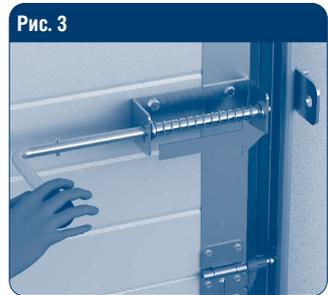
Передвинуть задвижку \* в сторону закрывания. Для зацепления с ответной частью, повернуть ручку задвижки параллельно полотну ворот \*.
